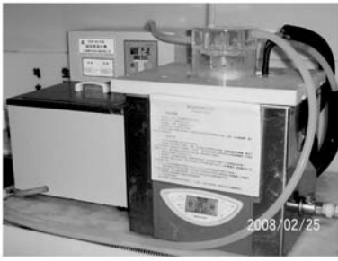
图 3 超声腐蚀系统实体图
